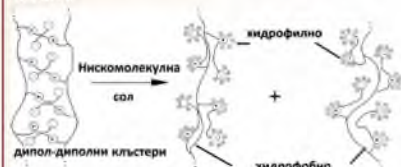
Схема 2. Дипол-диполни кластери в ПСБ и тяхното разрушаване при прибавяне на NaCl.
