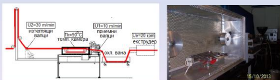
Фигура 3. Технологична схема и параметри за получаване микрофбрили
