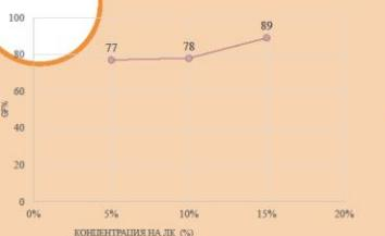
Фиг. 4. Зависимост на добива на гел фракция (GF) от концентрацията на лимонената киселина. Реакцията е проведена при нагряване за 10 мин. при температура 180°C.
