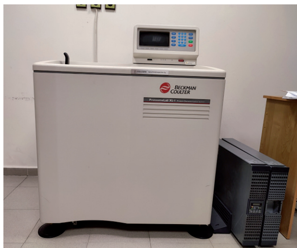
Фиг. 1. Аналитична ултрацентрифуга за изследване на свойствата на (био)макромолекулите в разтвор
